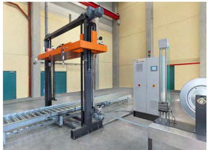
V-Umreifer Vertikale Umreifungsmaschine mit Verschluss am Palettenkopf für IKEA, Schweden.
