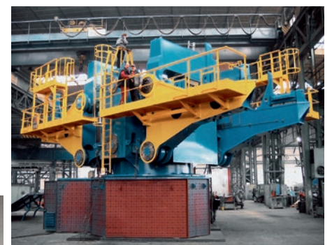
Pfannendrehturm für eine Brammenstranggussanlage.
